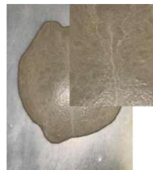
Apariencia con signos de exudación y sedimentación, signo de exceso de agua
