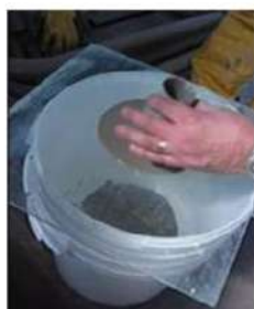
Levante el cono lentamente y deje que todo el material caiga del cono
